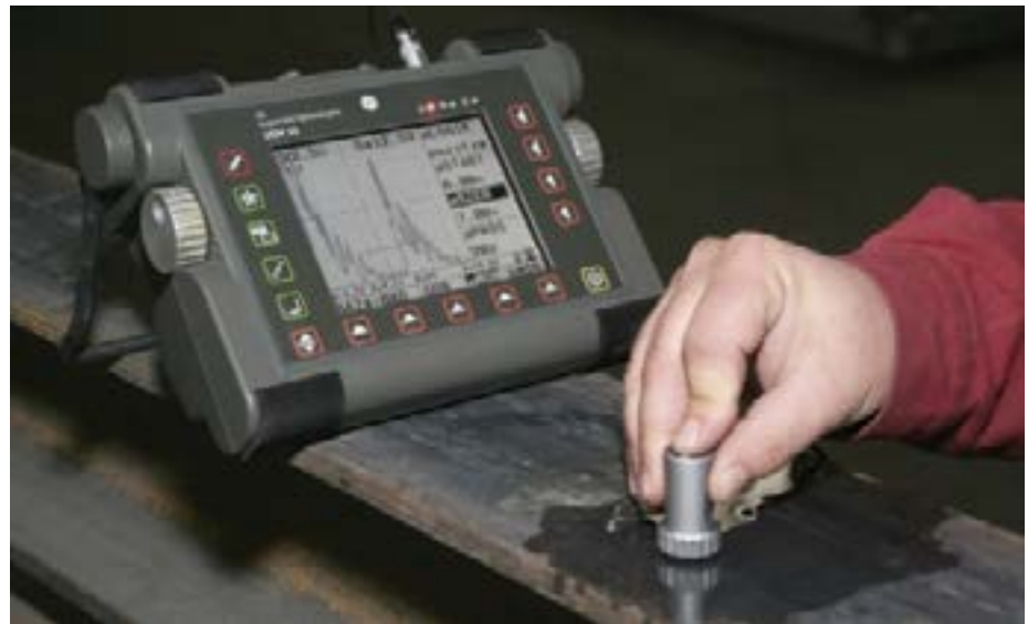
Wykonanie badania nieniszczącego spoiny
