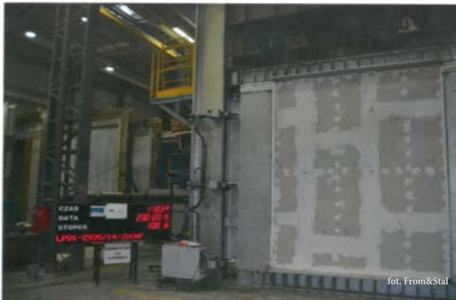
Widok elementu próbnego w 68 minucie badania (strona nienagrzewana).
